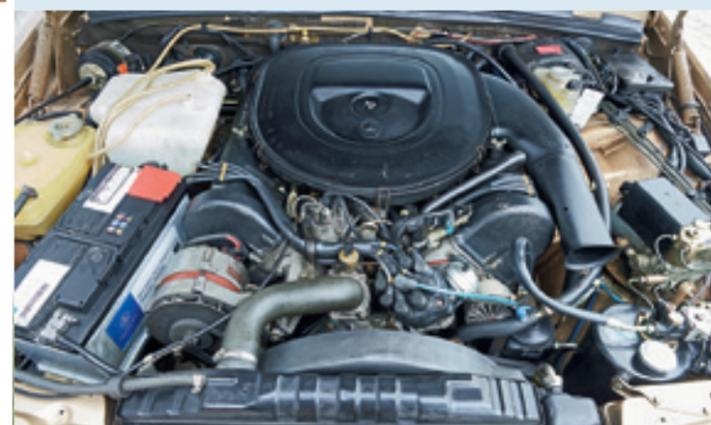
Komplexe Technik: 6,9-Liter-V8 mit Trockensumpfschmierung. Vorne rechts sitzt der Vorratsdruckbehälter der Hydropneumatik
